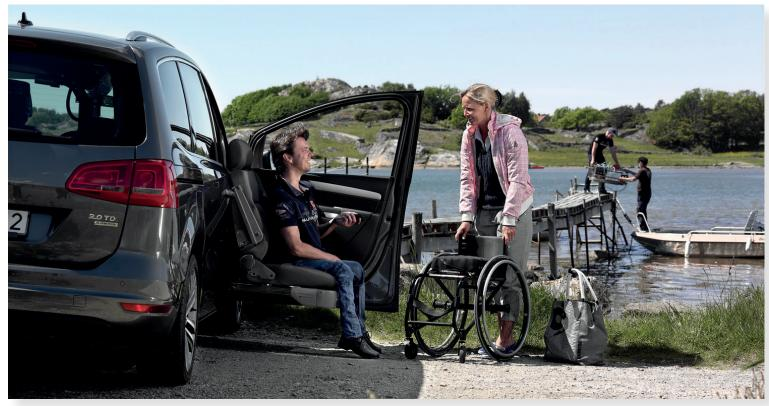
Le Turny est une embase pivotante vouée à présenter le siège conducteur ou passager du véhicule dans la position la plus appropriée pour un transfert simple, sans effort, ni contorsions. Une fois la rotation complètement opérée, le Turny s'abaisse pour présenter le siège à bonne hauteur.
